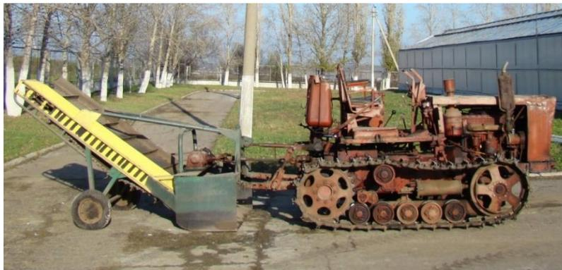
Рисунок 4 – Прицепная машина для удаления и погрузки санитарного слоя почвы
